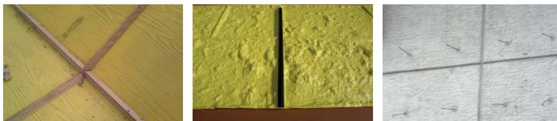
2.- A l'aide de scotch. (empreinte visible sur la face du béton).
