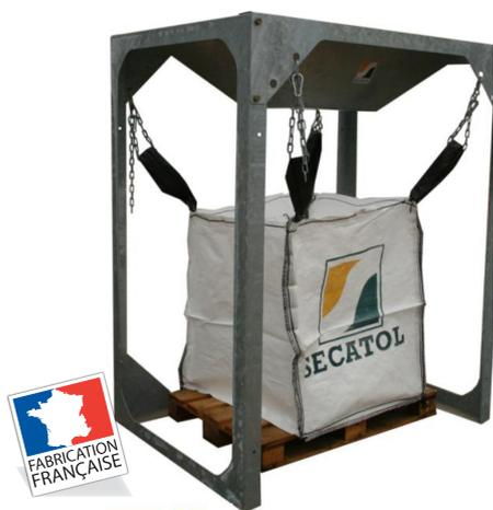
Pour le remplissage de big-bags à l'aide d'un godet ou d'une pelle basculante. Le Big-bag positionné sur une palette est maintenu en position ouverte grâce aux 4 chaînes d'accrochage. L'évacuation du Big-bag se fait par la face avant en reprenant la palette servant de support grâce à un chariot élévateur.
